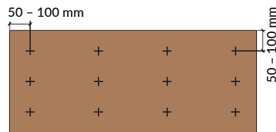
GUTEX Thermoroom® D 20 mm 12 nieten/schroeven per plaat
