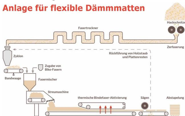
Abb.1: Schematische Darstellung des Herstellungsverfahrens der GUTEX Thermoflex.
